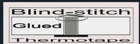
Une combinaison est conçue pour laisser le moins d'eau possible s'infiltrer ! Le montage des panneaux de néoprène en collé / cousu garantit des coutures 100% étanches. C'est de plus la technique d'assemblage la plus efficace et la plus solide.
