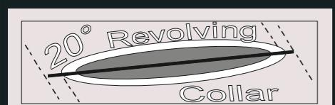
Le col assure une fonction essentielle sur la combinaison. Il doit à la fois fermer sans gêner. La position est modifiée : diminué en hauteur et basculé sur l'avant de 20°, il stoppe les entrées d'eau, se plaque idéalement sur l'arrière, et ne comprime pas le cou.
